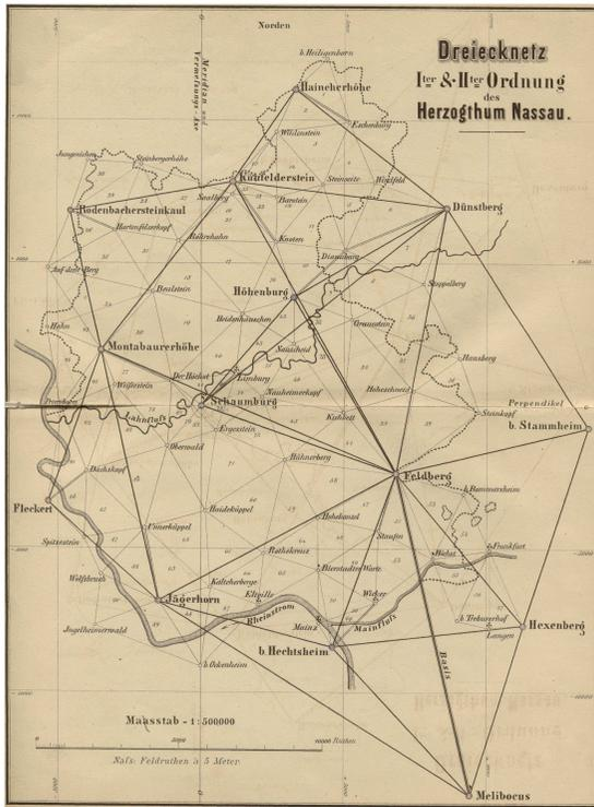
In diesem geodätischen Netz können für die Dreieckspunkte Koordinaten bestimmt werden, wozu Formeln der Trigonometrie angewendet werden. Damit diese Trigonometrischen Punkte (TP) für spätere Vermessungen genutzt werden können, wurden sie dauerhaft und identitätssicher vermarktet. Dies geschah über besonders ausgestaltete schwere Steinpfeiler aus Granit, Basalt oder Sandstein, die teilweise auch unterirdisch gesichert wurden.
